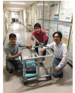
マルチコプターに使用するプロペラとモータの特性を計測する装置とともに。
