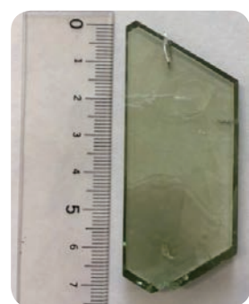
図2：実際に育成した ZnO バルク単結晶
